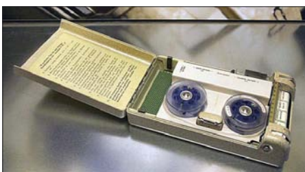
Bild 12: Tondraht-Diktiergerät „Minifon Attache“, Protona, gebaut 1958 bis 1962, vier Transistoren, auch für Spionage mit Mikrofon in Krawattennadel oder Uhr
