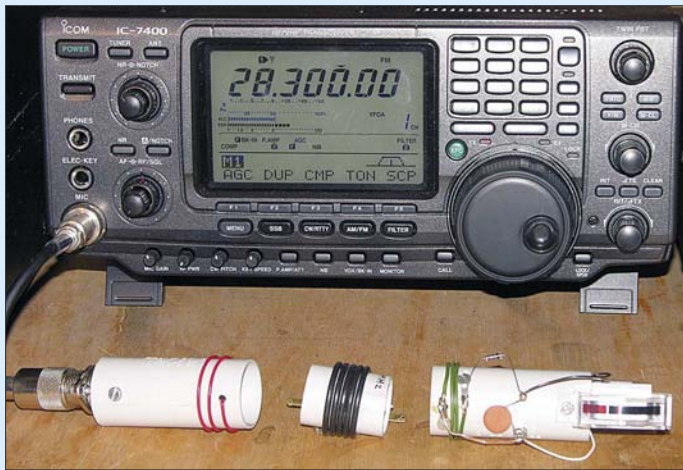
Bild 6: Praktisches Ausmessen eines Koaxialkabeltraps für 28,3 MHz
