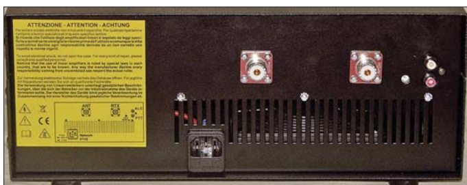
Bild 7: An der Rückseite sind neben den beiden HF-Buchsen PTT-Eingang und ALC-Ausgang in Cinch-Norm angebracht.
