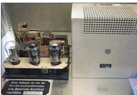
Bild 10: Telefunken-Ela-Verstärker von 1937 mit zwei AD1, 10 Watt Ausgangsleistung
