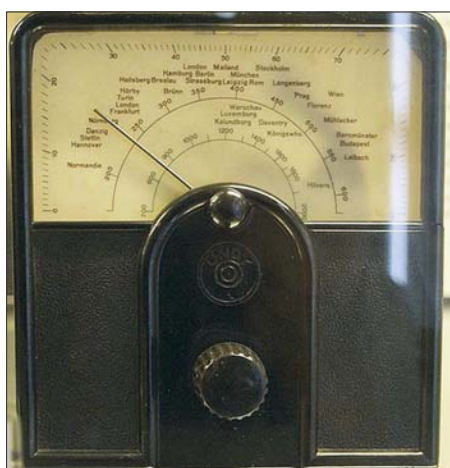
Bild 8: Skala mit Beleuchtung für den Volksempfänger 11, ab 1935 für 8 Reichsmark erhältlich: Auch „Feindsender“ waren hier noch verzeichnet!
