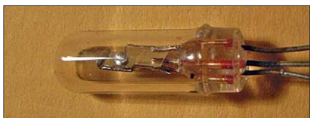
Bild 1: Kein Selbstbau – Transistor OC44 im Glasgehäuse Fotos: Sander
