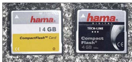
Bild 1: Standard- und Hightech-Compact-Flash-Karten von Hama; interessant ist das unauffällige Label als „Class 2“ bzw. „Class 6“, obwohl diese neue SD-Nomenklatur für Compact Flash bislang nicht propagiert wird.
