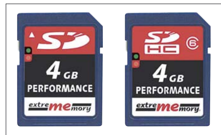
Bild 3: Kaum unterscheidbar, doch keine Zwillinge: Links eine 4-GB-SD-Karte, rechts ihr SDHC-Pendant. Wenn überhaupt, wird nur eine von beiden in der eigenen Kamera funktionieren.
