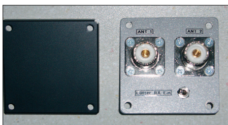
Bild 2: Eigenbau-Abdeckung mit montierten Buchsen sowie Lüfterschalter, links Original
