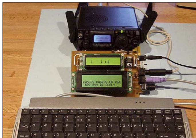
Wie PSK ohne Computer funktioniert, zeigt der AM-QRP-Club um George, N2APB.
