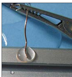
Bild 2: Signale lassen sich aus einem Salz wassertropfen erzeugen.
