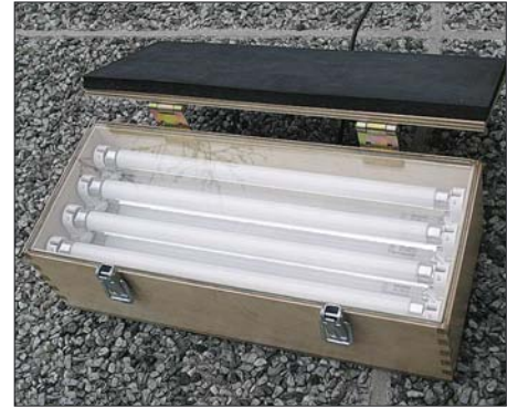
Bild 4: Beleuchtungsgerät im innen verspiegelten Sperrholzkasten
