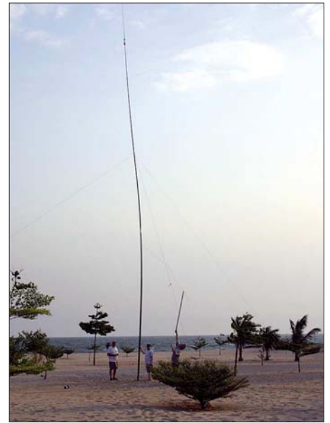
Ein Element der 80-m-phased-Vertikal ist aufgestellt
