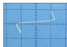
Bild 4: Kennlinie der Diode mit negativem differentiellen Widerstand
